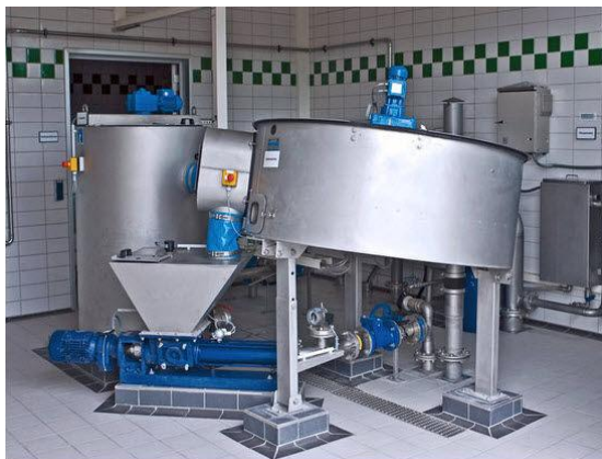
2.9. Primjer disk ugušćivača s flokulant stanicom
