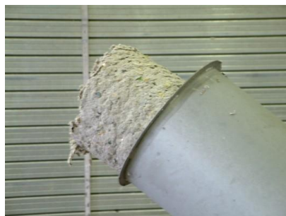
Slika 2.3. Sadržaj sakupljen na automatskoj finoj rešetki
